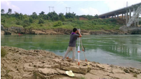
图 2.9 现场全站仪观测照片
