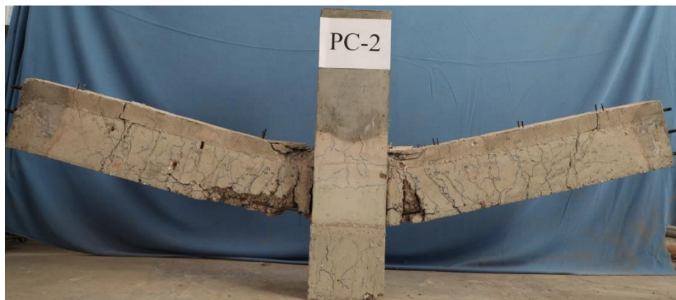
a) PC2 试件破坏模式图
