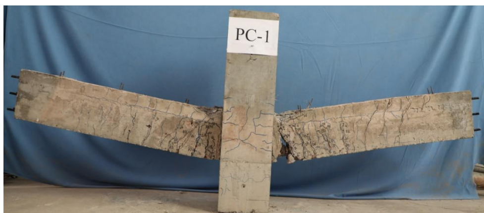
图 3.26 PC1 试件破坏模式图
