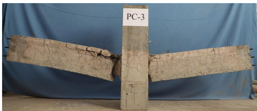
图 3.32 PC3 试件破坏模式图
