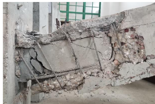
c) U型钢筋滑移失效
