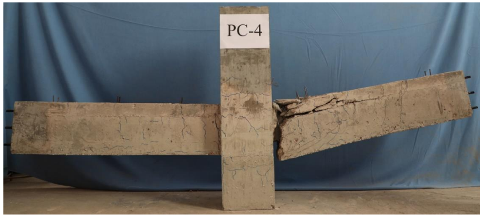
图 3.35 PC4 试件破坏模式图
