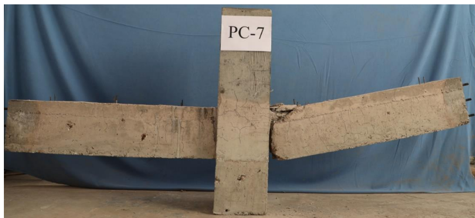
a) PC7 试件最终破坏形态
