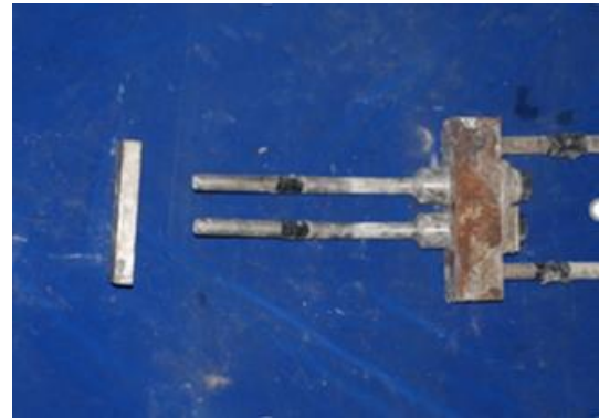
f) 延性杆断裂
