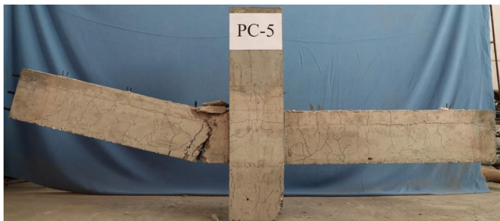
a) PC5 试件最终破坏形态
