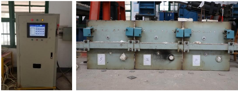
a)高温试验炉控制柜
