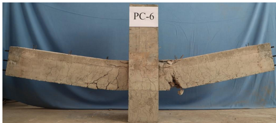
a) PC6 试件最终破坏形态
