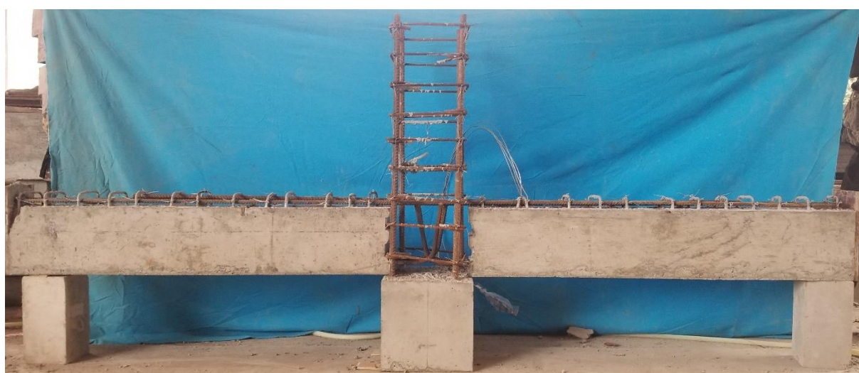
图 2.5 预制部分拼接完成示意图
