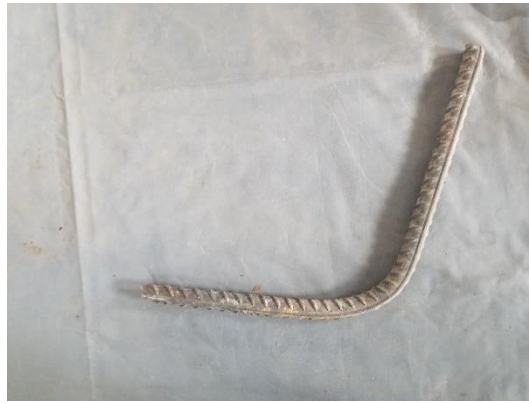
b) 90° 锚固钢筋滑移
