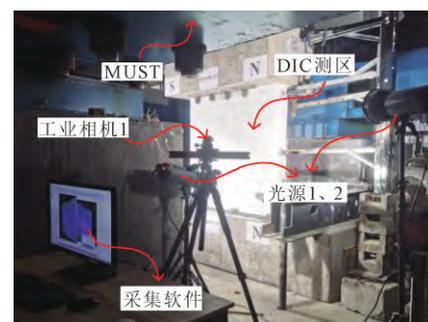
图4 试验中采用的 DIC 测量系统
