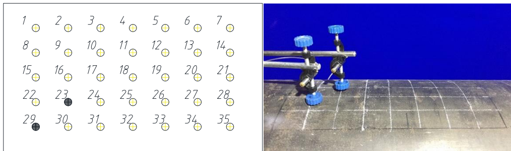
图 3.30 钢管混凝土构件的声模态测试测点布置图
