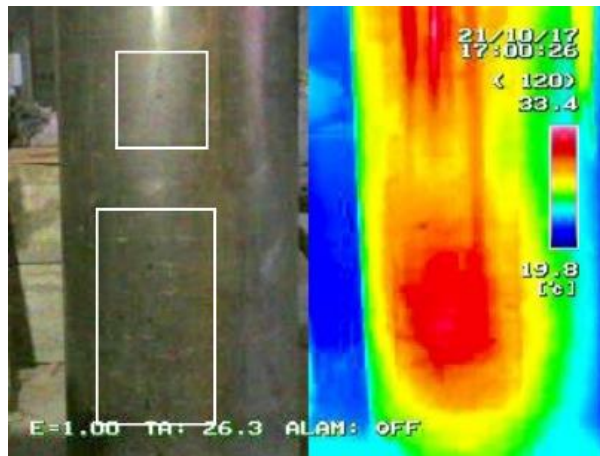
图 5.11 钢管混凝土构件均匀加热后的温度场分布
