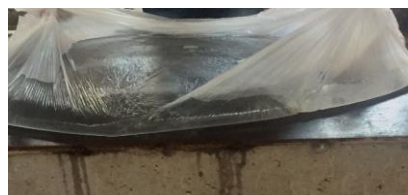
图 5.7 钢-混凝土组合板构件均匀冷却
