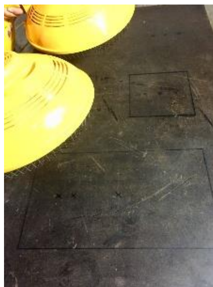
图 5.4 钢-混凝土组合板构件均匀加热
