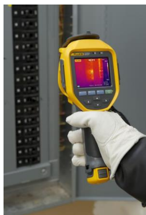
图 1.8 红外热像仪摄像捕捉温度场
