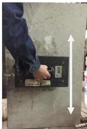
图 5.28 雷达法测钢-混凝土组合板构件
