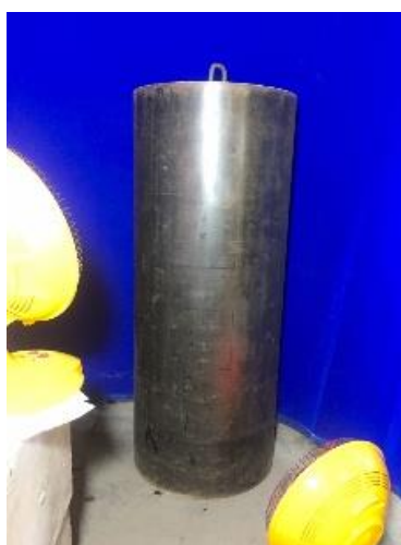
图 5.9 钢管混凝土构件均匀加热
