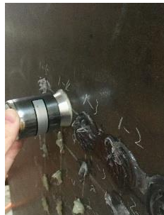
图 5.17 测试时发射探头与接收探头的放置
