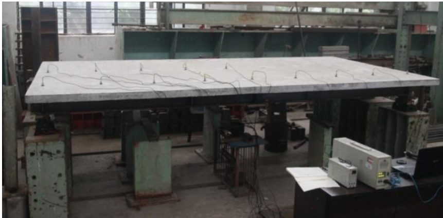
图 3.3 钢-混凝土组合板动力试验照片
