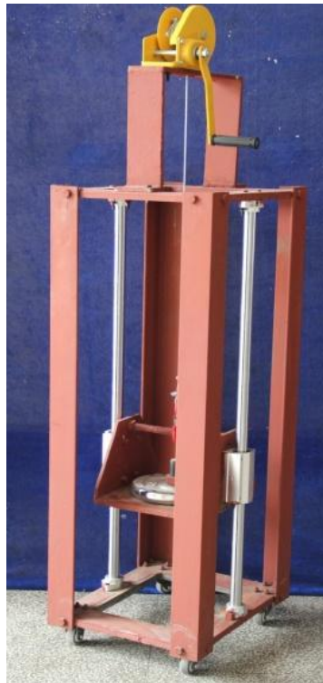
图 3.25 湖南大学研制脉冲锤击法落锤
