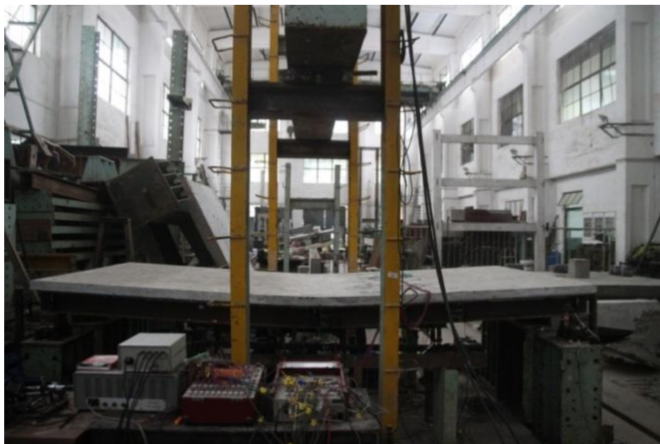
图 4.22 钢-混凝土试验板破坏状态下的变形
