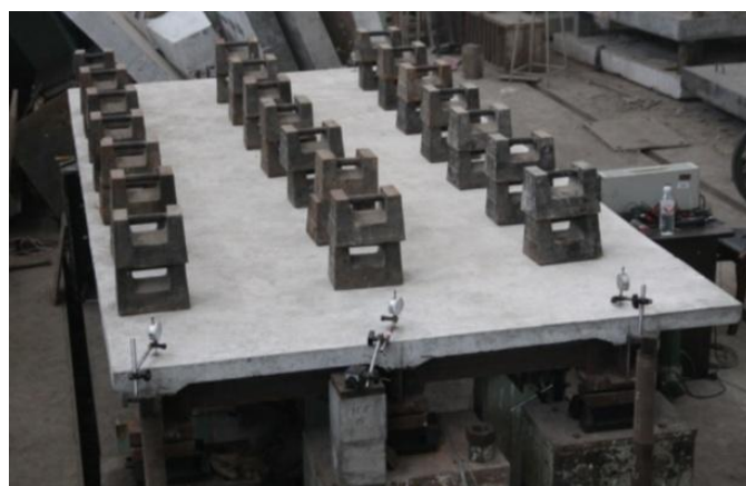
图 3.7 钢-混凝土组合板的砝码均布加载试验
