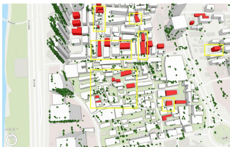
图 6.7 本方法区域漏检建筑空间分布图
