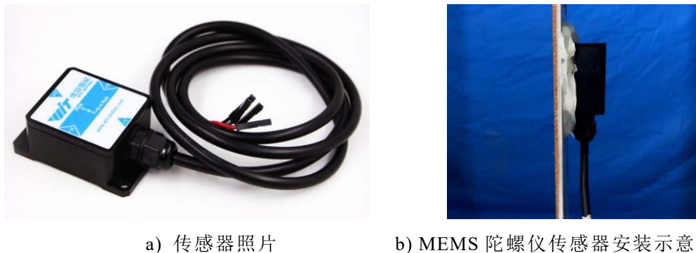
图 2.25 MEMS 陀螺仪传感器照片及安装示意图
