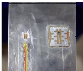
图 4.20 RFID 应变传感器和应变片粘贴方式
