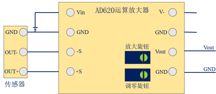
图 3.9 AD620 运算放大器差分输入接线图
