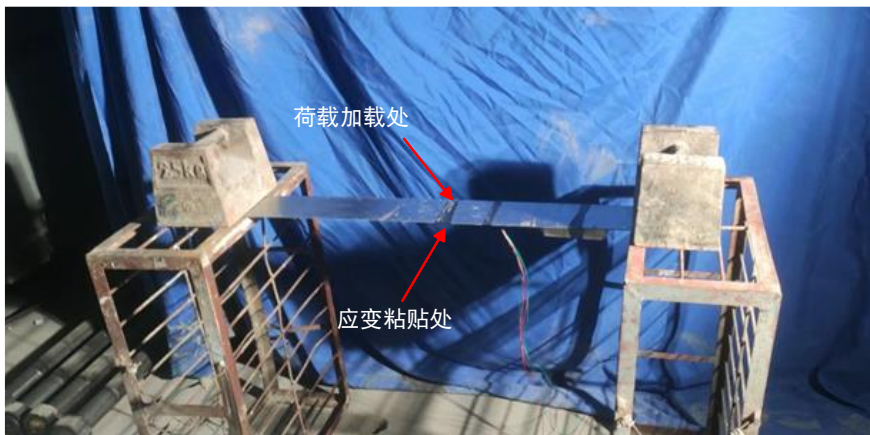
图 3.6 钢板简支梁试探性加载实验
