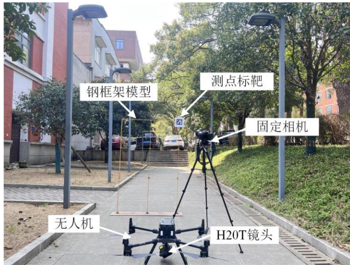
图 4.5 室外钢框架模型试验装置
