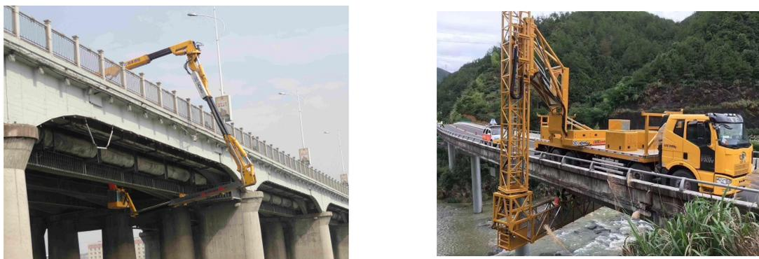
图 1.2 人工检测桥梁方法
