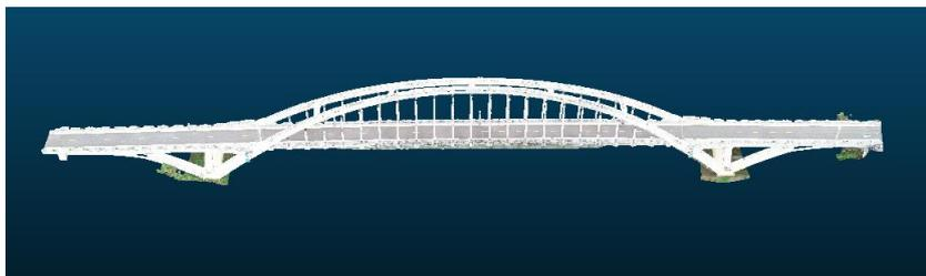
a) 2023 年 3 月 21 号采集的桥梁点云模型
