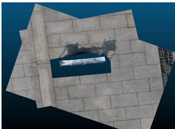
图 4.14 点云模型配准结果
