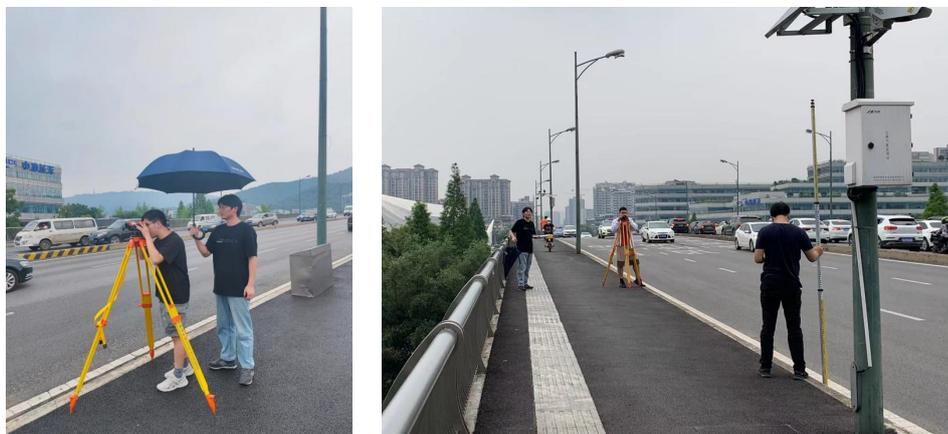
图 5.5 桥面线型测试测站设置及跑尺照片
