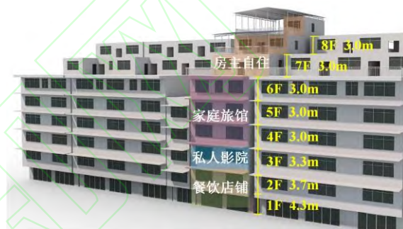
图 1 房屋倒塌前状态
