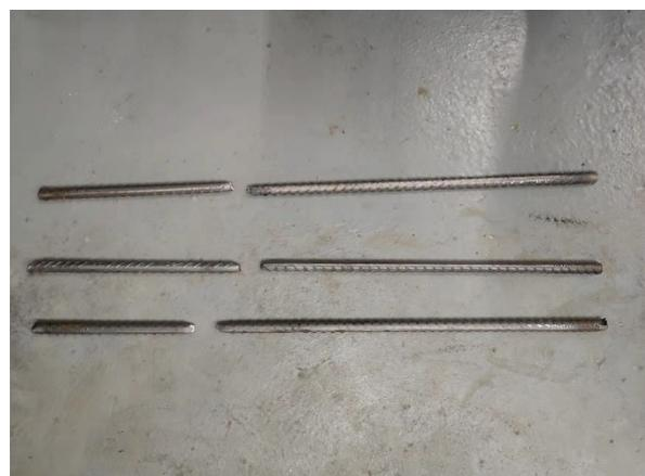
b) 钢筋断裂形态
