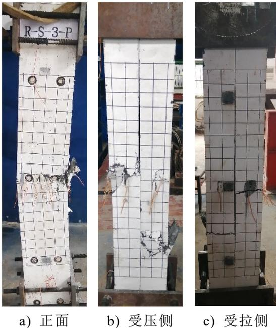
图 3.5 R-S-3-P 试件破坏形态图
