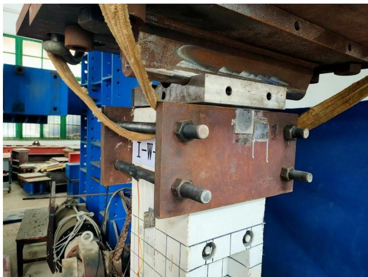
图 2.6 加载板实物图
