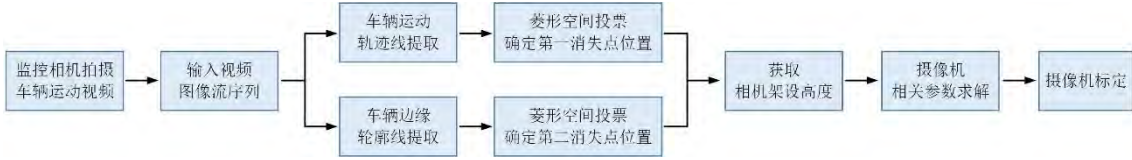
图 5.9 基于消失点理论的相机自标定方法流程图
