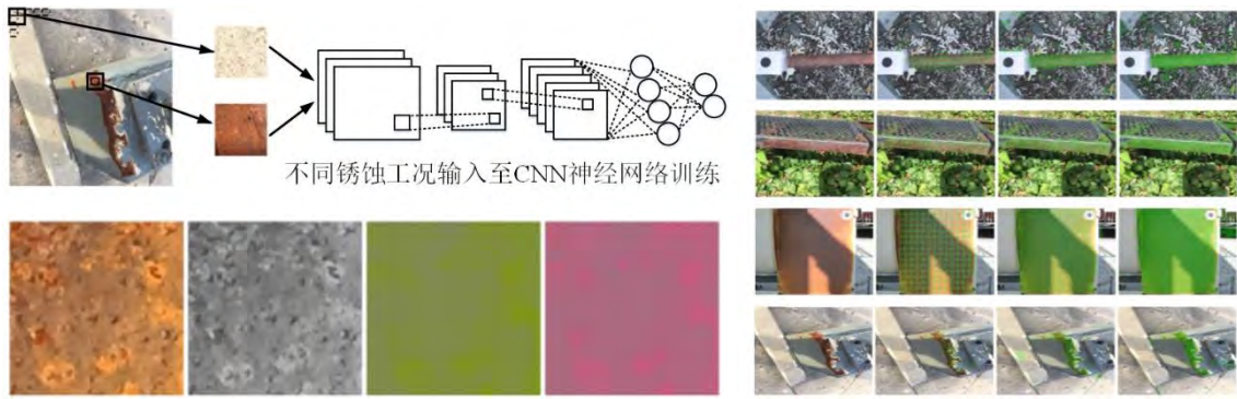
图 1.8 基于 DCNN 网络的钢结构锈蚀识别方法
