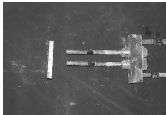
图 14 延性杆断裂情况
