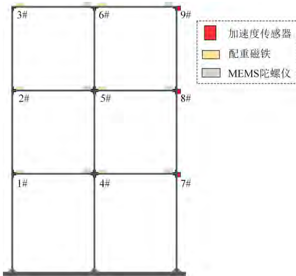
图 5.8 钢框架模型模态试验测点
