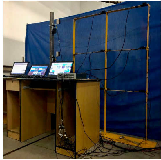
图 5.9 钢框架模型模态试验
