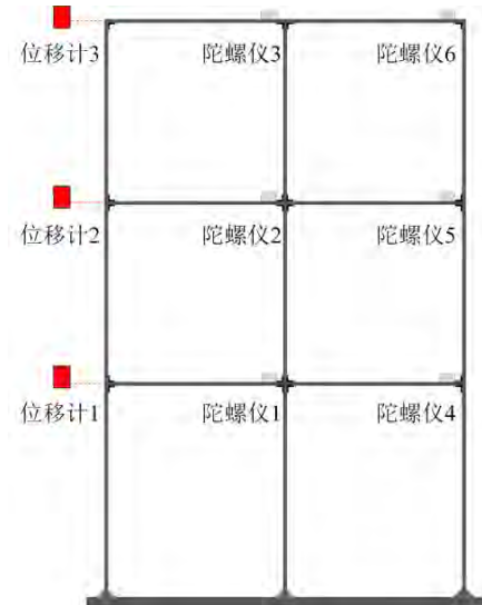
图 5.5 钢框架模型静载试验
