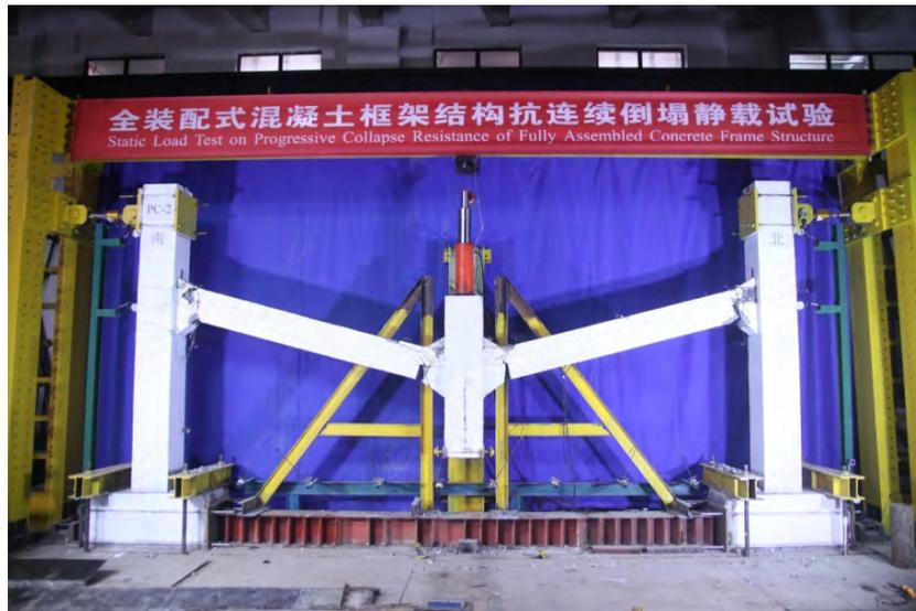
图 2.11 PC2 整体构件破坏图<sup>[92]</sup>
