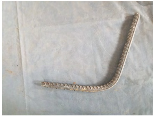
b) 90° 锚固钢筋滑移
