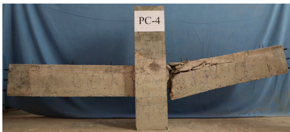
图 3.35 PC4 试件破坏模式图
