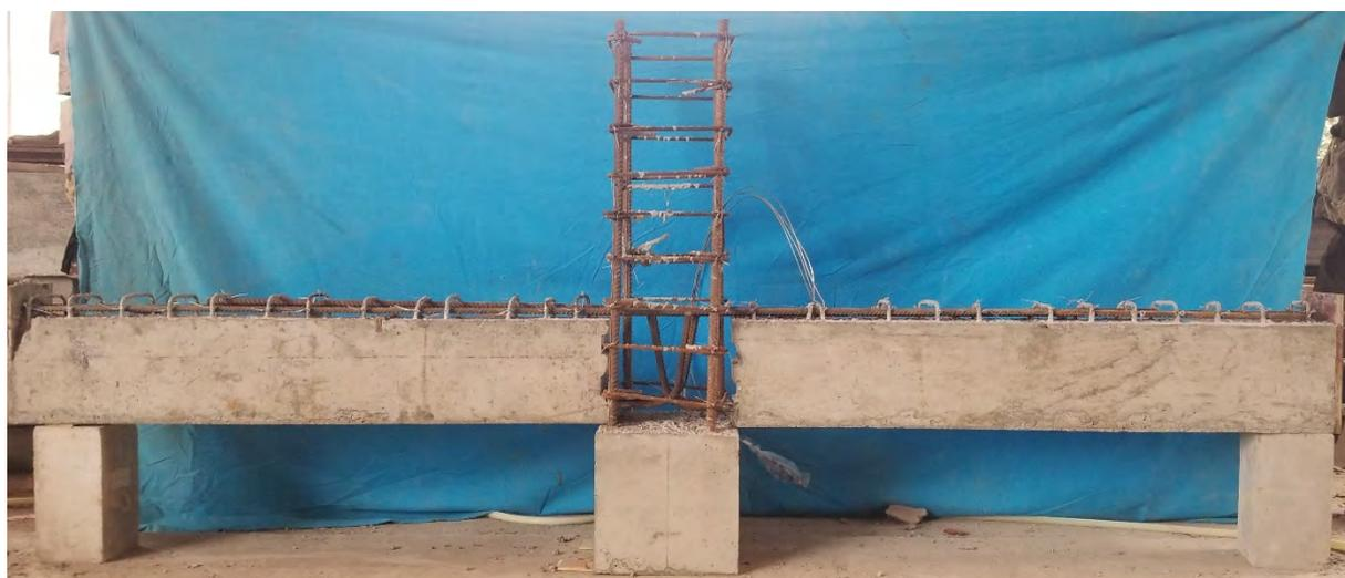
图 2.5 预制部分拼接完成示意图
