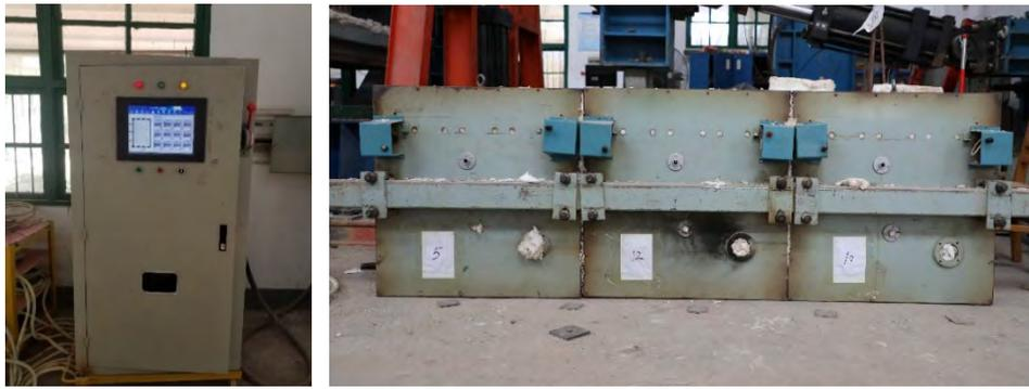
a)高温试验炉控制柜
