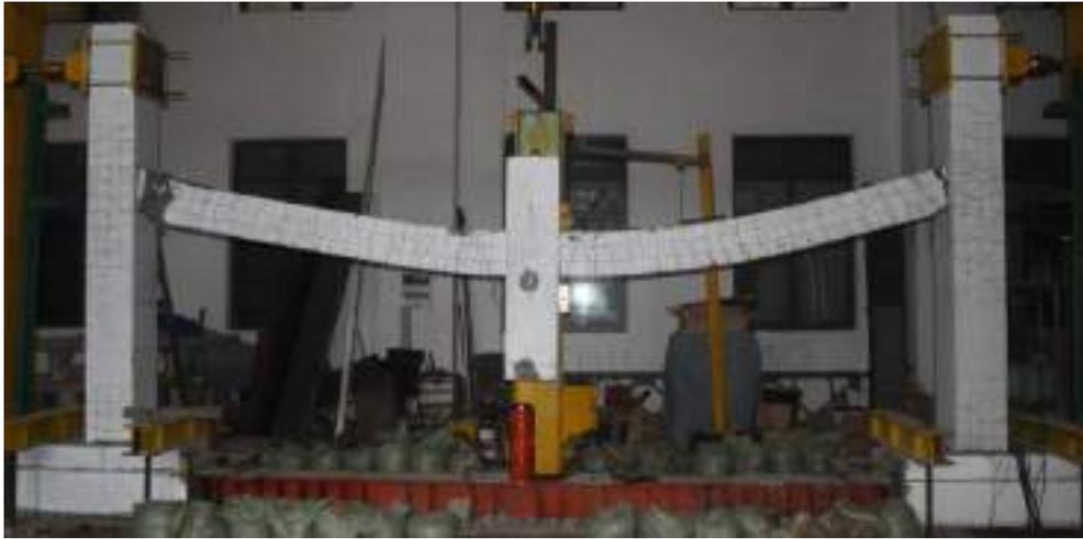
a) RC 试件倒塌后整体照片
