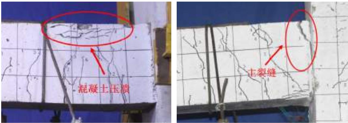
a) 中节点梁端混凝土压溃
