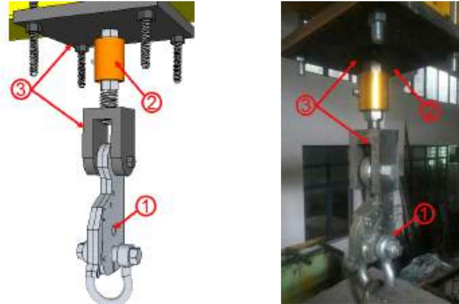
注：①10t 拉绳式脱钩器；②10t 荷载传感器；③连接装置。
