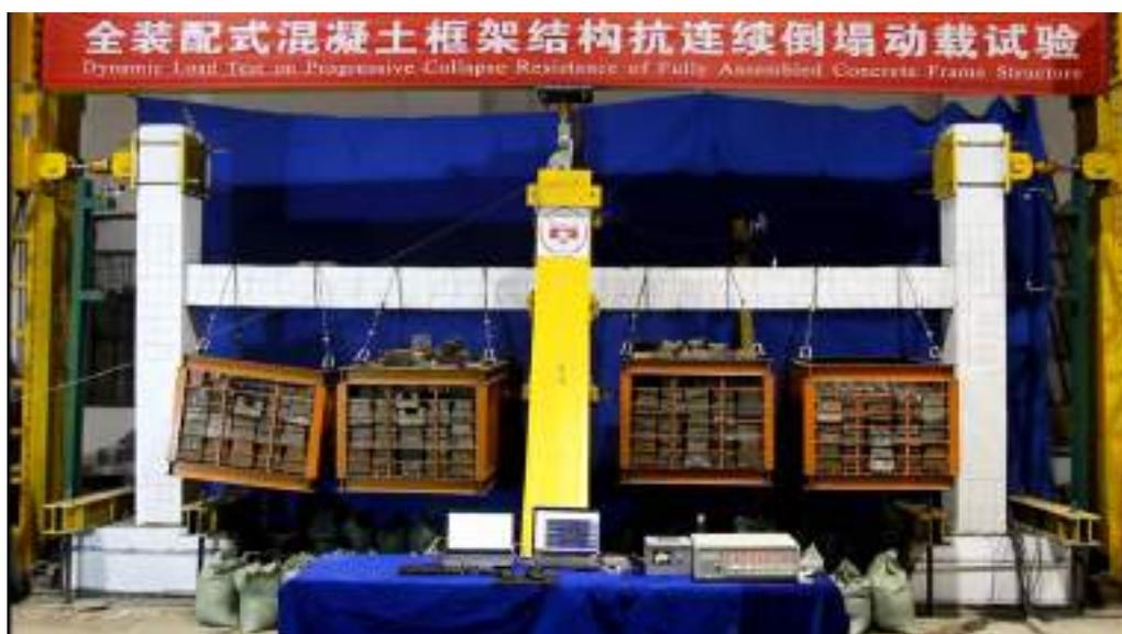
图 3.48 第五级轴力释放完成试件照片
