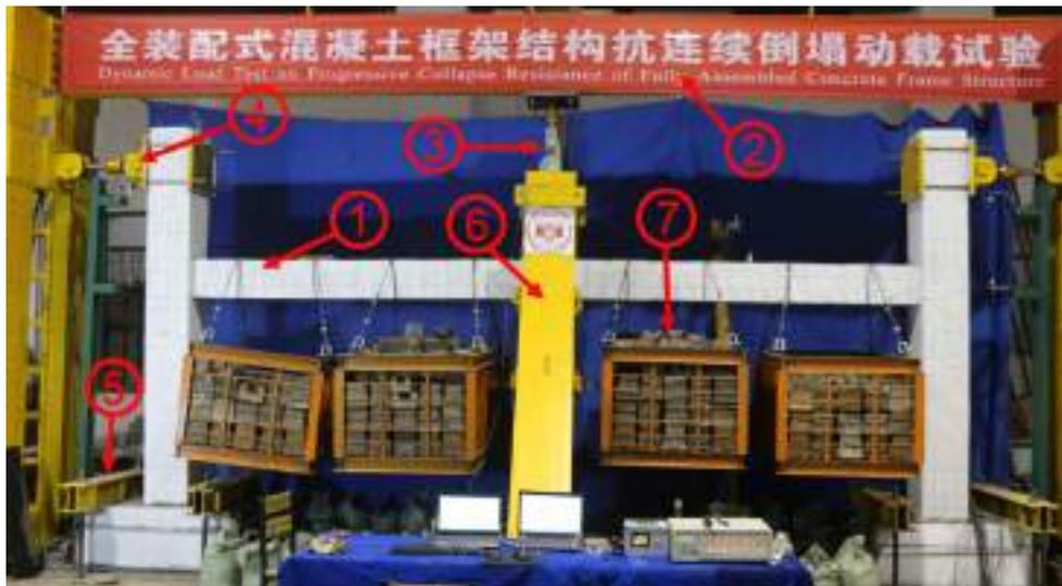
注：①试件；②钢架加载装置；③中柱脱钩装置；④边柱侧向铰接约束装置；⑤地梁约束装置；⑥中柱侧向约束装置；⑦梁身重物加载装置。
