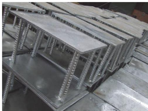
b) 河北某工厂加工的混凝土预埋件
