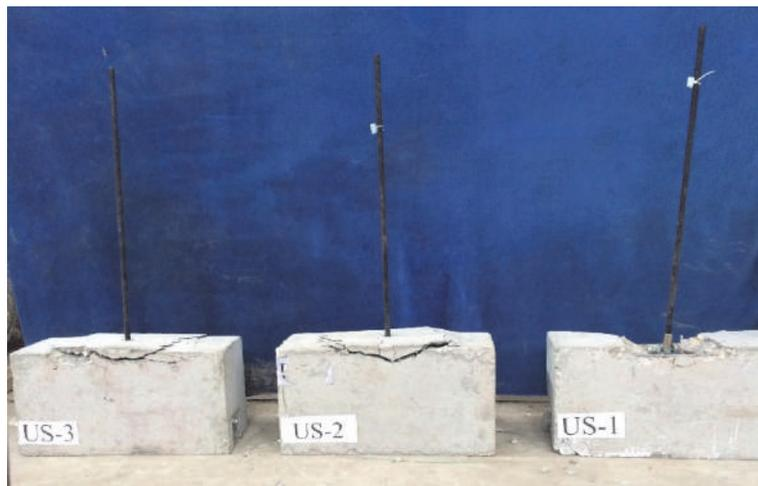
图 2.17 预埋套筒端试件破坏形态汇总
