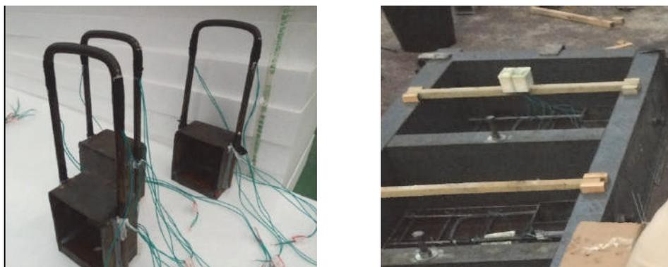
图 2.10 预埋连接盒端试件工厂制作过程
