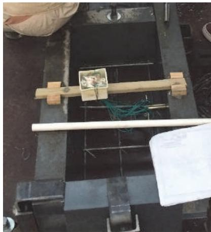
图 2.8 预埋套筒端试件工厂制作过程
