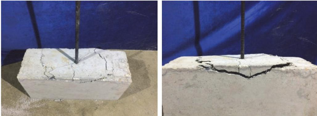
图 2.15 US-2 破坏形态照片
