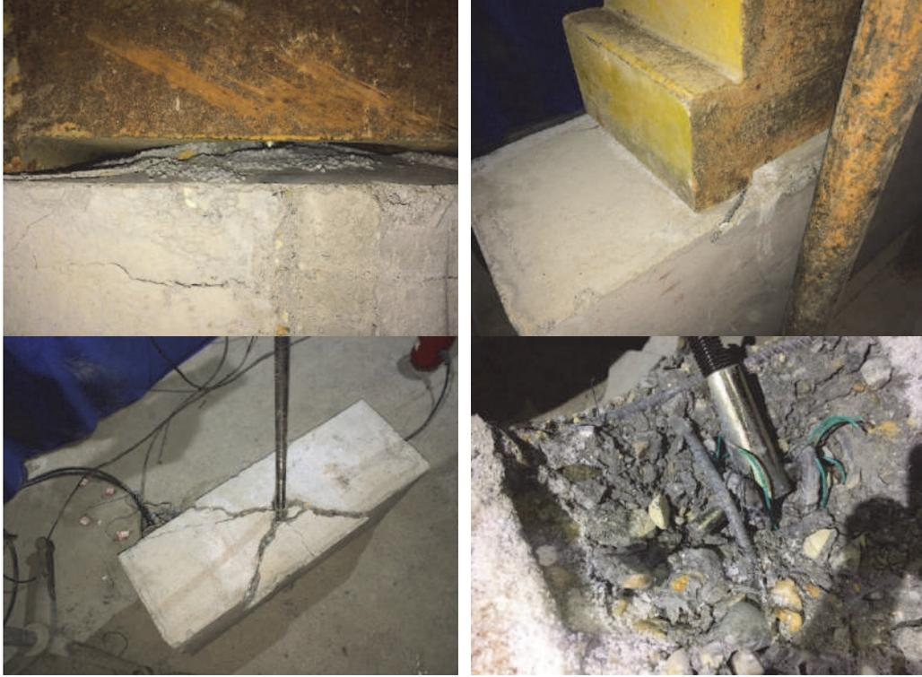
图 2.14 US-1 破坏形态照片
