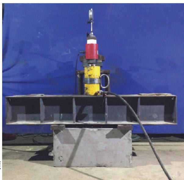
图 2.12 预埋套筒端抗拔试验装置图
