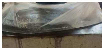
图 5.7 钢-混凝土组合板构件均匀冷却
