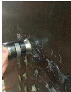
图 5.17 测试时发射探头与接收探头的放置
