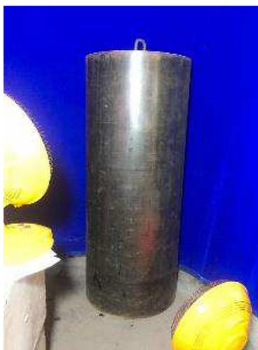
图 5.9 钢管混凝土构件均匀加热
