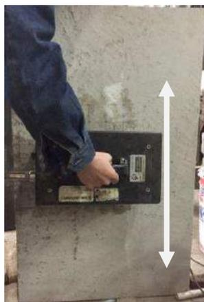
图 5.28 雷达法测钢-混凝土组合板构件
