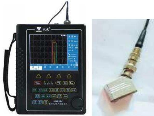
图 5.21 汉威 HS610e 钢结构超声波探伤仪及斜探头
