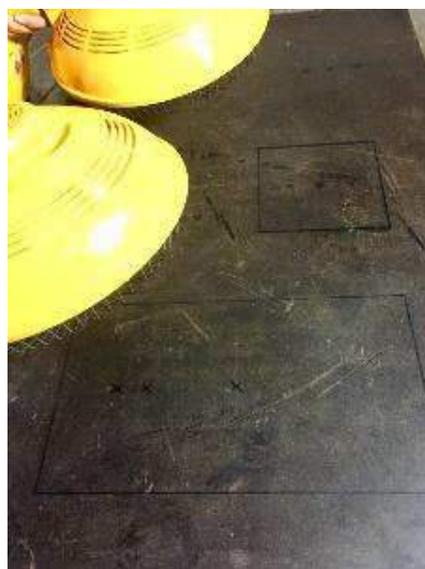
图 5.4 钢-混凝土组合板构件均匀加热
