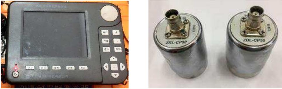
图 5.15 BL-U520 非金属超声波检测仪和 ZBL-CP50 探头
