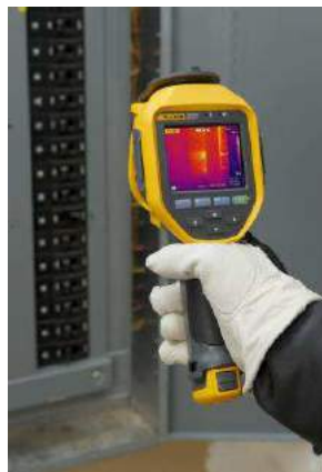
图 1.8 红外热像仪摄像捕捉温度场
