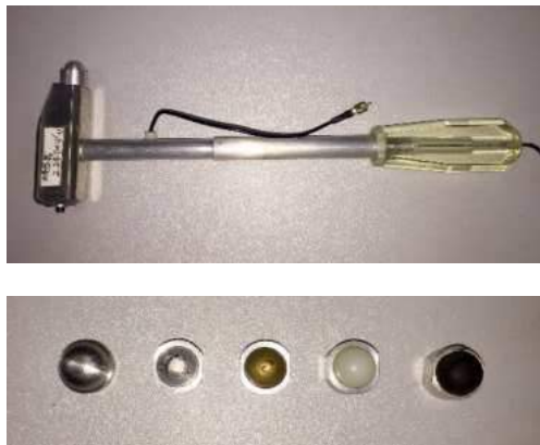
a)PCB 模态力锤与各材质的锤头
