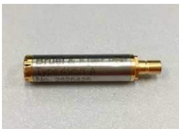
c)B&K 1/4 英寸麦克风传声器
