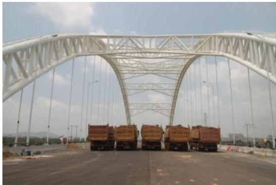
图 4.11 载重卡车加载试验照片（主跨 1/4 位置加载 5 台卡车）
