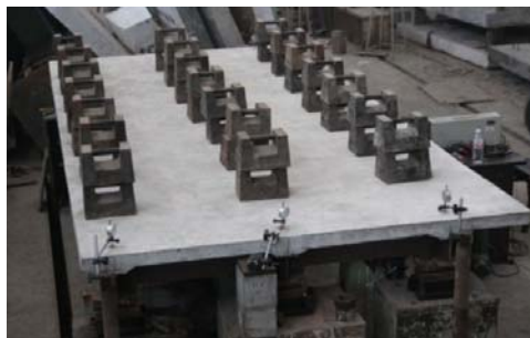
图 3.21 钢-混凝土组合板的均布集中力加载照片
