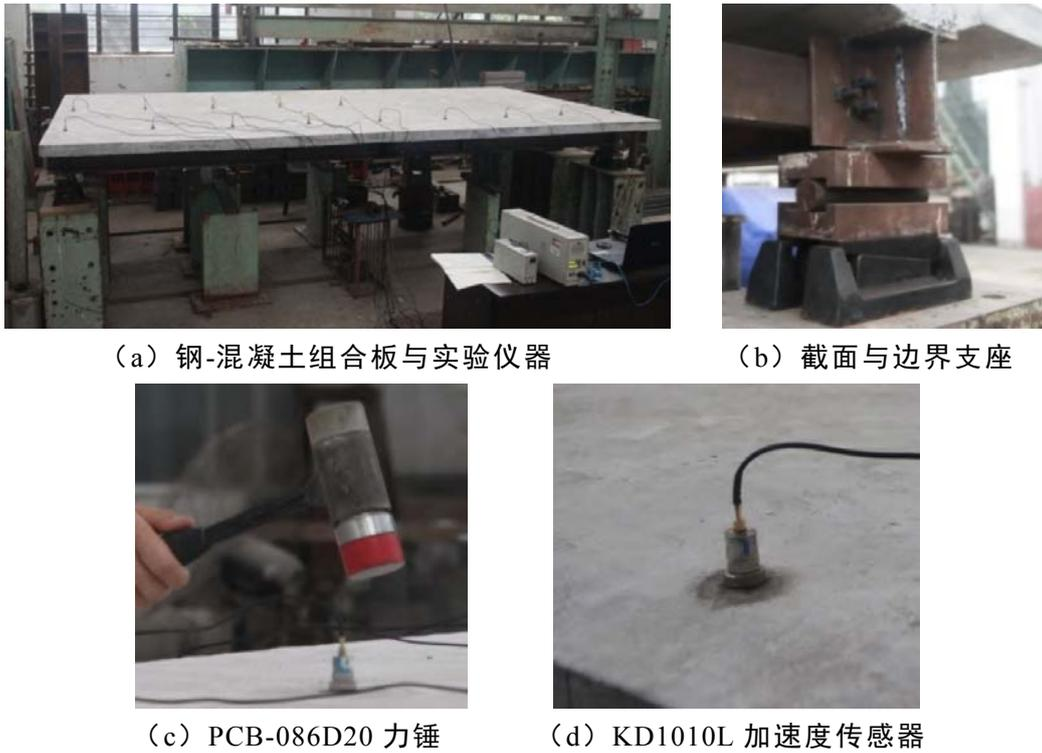
图 3.4 钢-混凝土组合板动力试验照片<sup>[81]</sup>
