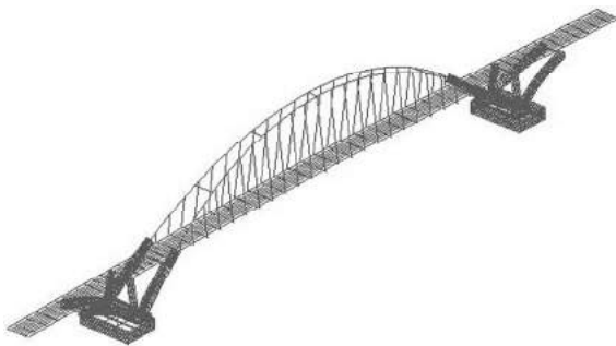
图 16 巴溪洲桥校验模型 Fig. 16 Calibrated model of Ba Xi Zhou Bridge
