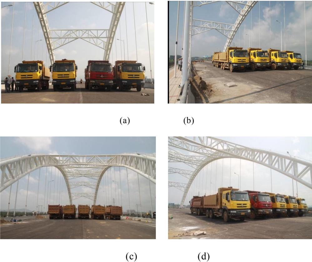
图 2.5 载重卡车加载试验照片 (a)主跨 1/2 位置对称加载 4 台车；(b)主跨 1/2 位置对称加载 8 台车；(c)主跨 1/4 位置加载 5 台车；(d) 主跨 1/4 位置加载 10 台车
