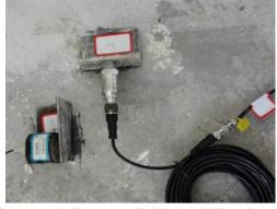
房屋结构的总高度为 9.75 米,建筑面积为 285 平方米。据目前掌握的资料,此次全装配式结构 1: 1 实体抗震实验是世界首例。试验准备了 3 块共计 5.3 吨的配重钢板,通过安装在房屋顶部的电液伺服激振器以结构自振频率激励结构共振,模拟房屋结构在地震下的受力性能。试验中布置了一系列的加速度、位移及应变传感器,获得了大量足尺装配式结构抗震性能的试验数据。
