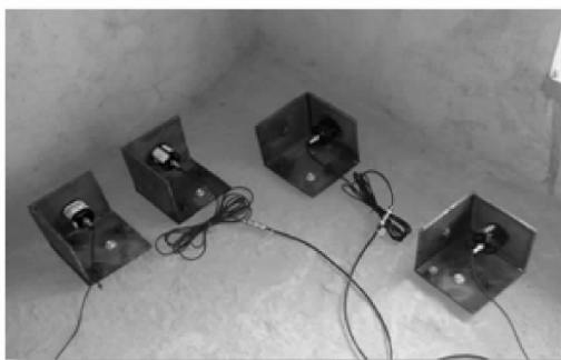
(b) 4 个加速度传感器测试 图 2 高层建筑现场测试仪器
