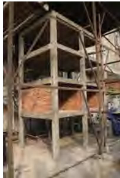
b) 模型 2: 粘土砖框架
