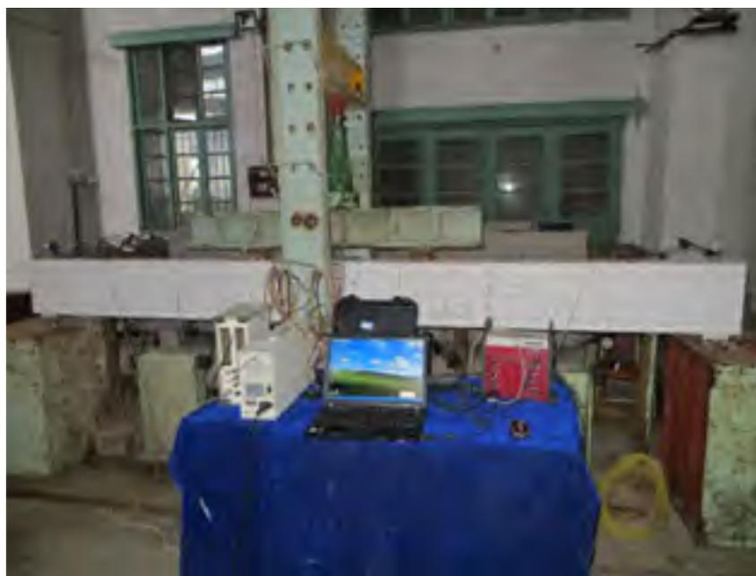
图 3.7 钢筋混凝土简支梁的静载试验照片
