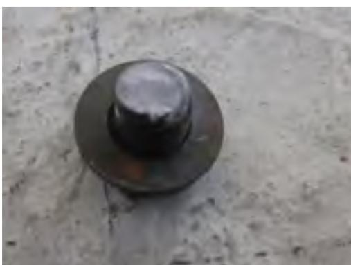
(d)螺栓套筒连接件破坏照片
