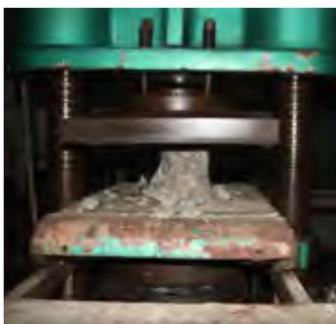
(a) 混凝土抗压强度试验
