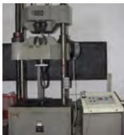
(b) 钢筋拉伸试验
