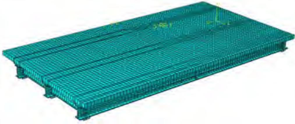
图 4.12 钢-混凝土组合板的 ABAQUS 有限元模型网格划分
