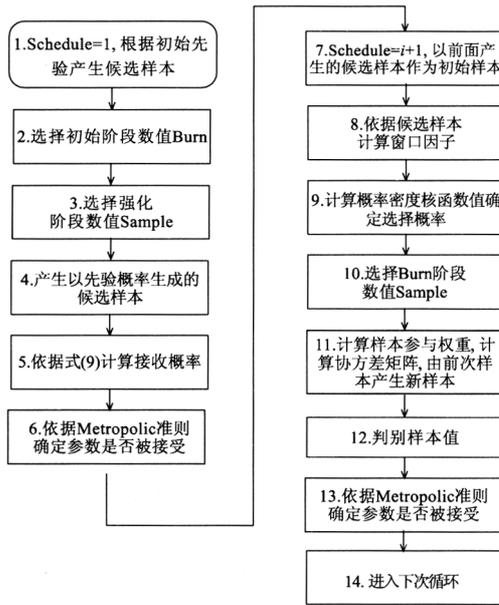
图1 MCMC 计算方法流程图
