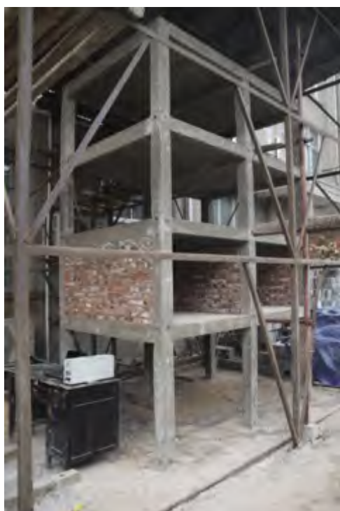
(c) 工况 3: 填充墙框架
